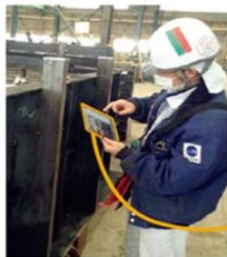
“検タス”とBIMを連携することにより、柱や梁、床などの躯体が、工場製作中、製作済、取付済なのかを“見える化”した
